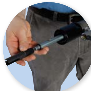
FTPLSAA y PL688 acoplándose a la tuerca de acoplamiento
